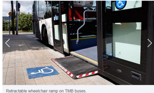
afbeelding 2.4 Uitschuifbare rolstoelplank in TMB bussen - Barcelona
